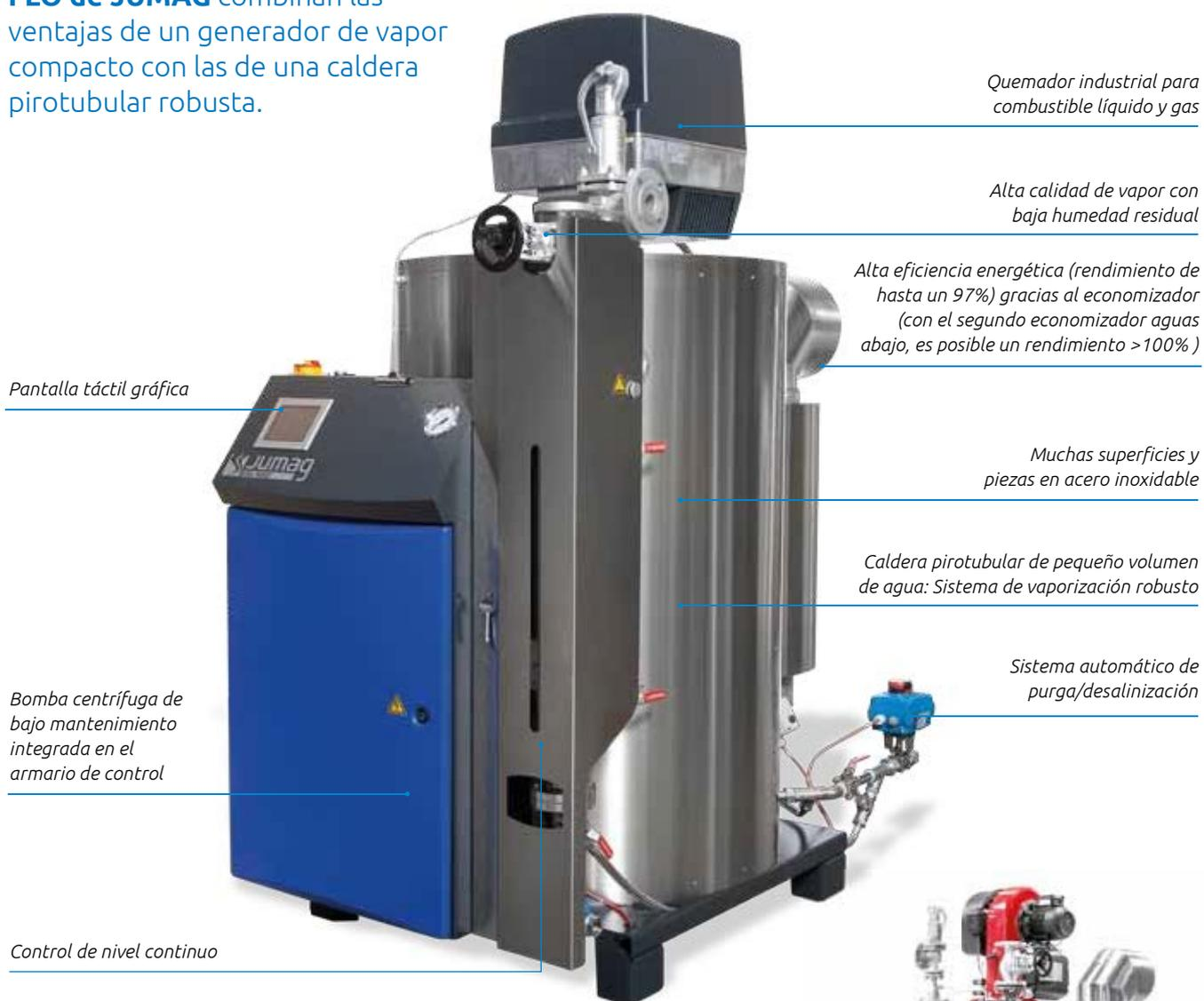
Fig.: Generador de vapor DG560 JUMAG
