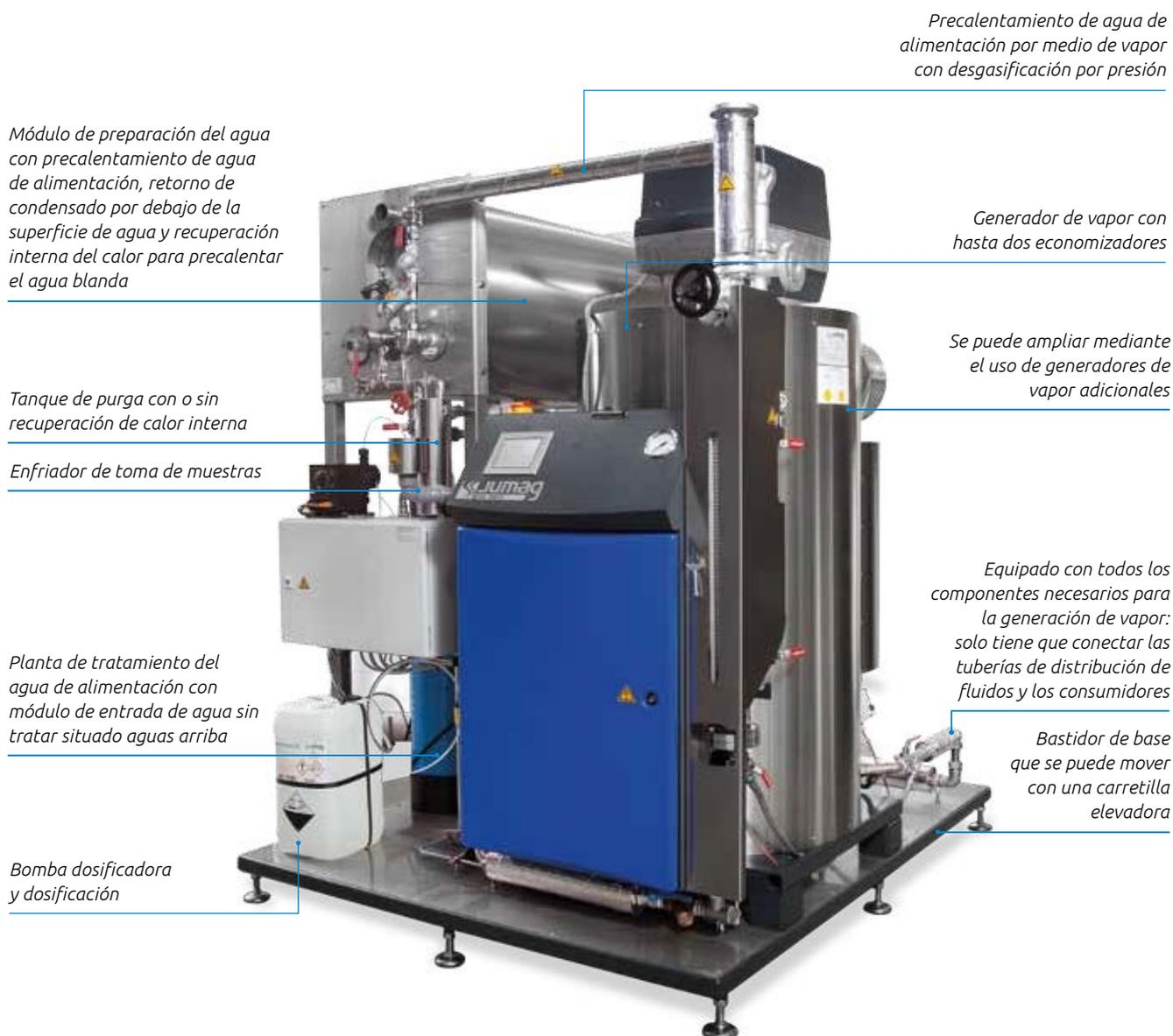
Fig.: Instalación de vapor compacta, ejemplo de configuración
